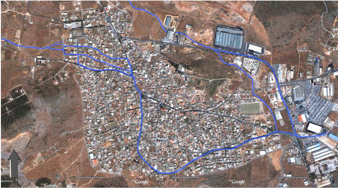
Εικόνα 2-2: Η πόλη της Μάνδρας δομημένη πάνω στο ρέμα και τις αναβαθμίδες του κλάδου της Αγ. Αικατερίνης. Στα βόρεια διακρίνονται βιομηχανικά κτίρια πάνω στη κοίτη του Σούρες εγκάρσια προς τη διεύθυνση ροής. Απεικονίζεται επίσης η διαδρομή που ακολούθησε το νερό κατά την πλημμύρα της 27 Ιαν. 1996, ακολουθώντας το οδικό δίκτυο, το οποίο στο μεγαλύτερο τμήμα του είναι μπαζωμένος χείμαρρος.
